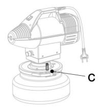
Per ottenere una rotazione di 180°, rimuovere il perno dalla posizione ed installarlo nella posizione B. Installare nella posizione C il secondo perno presente nella confezione.
