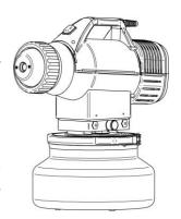
Il filtro antipolvere collocato in aspirazione, garantisce un funzionamento per lungo tempo e una nebulizzazione stabile e priva di particelle estranee alla formulazione. La particolare struttura del NEBULO EVO, permette un facile controllo ed eventuale rapida sostituzione del filtro in carta.
