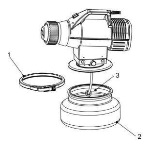
Riposizionate il corpo dell'apparecchio sul serbatoio e serrate l'anello di chiusura (1).
